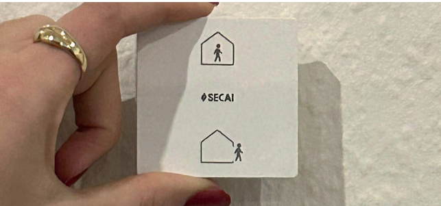
Abbildung 2: Ich bin dann mal weg: Mit den montierten Anwesenheitstaster in den Wohnungsfloren kann der Heizung signalisiert werden, ob jemand zu Hause ist.
